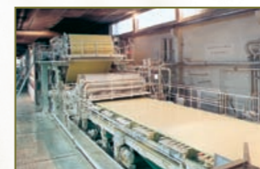
1 Langsiebpapiermaschine mit Siebpartie
