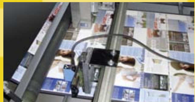
NEU: Inline-Nummerierung im Rollenoffsetdruck bei einer Geschwindigkeit von 45.000 Exemplaren in der Stunde.
