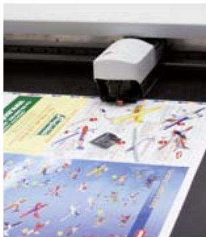
Axiscolor – für direkte Farbmessung und On-line-Farbregelung an der „Speedmaster CD74“.
