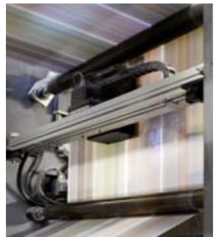
An der „POLYMAN 45“ kommt das modernste Farbmess- und Regelsystem „IDS“ zum Einsatz.
