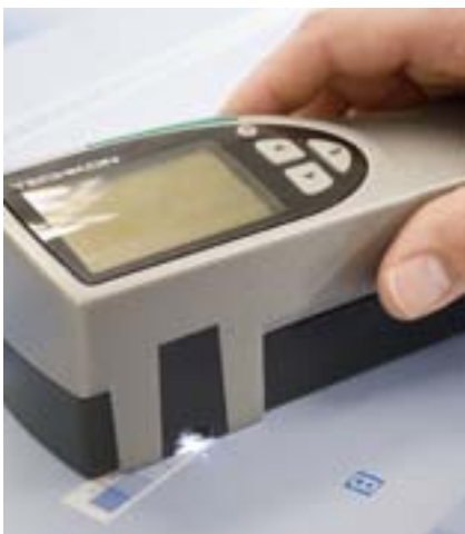
Permanente Druckplattenkontrolle mit dem Bildanalysegerät „Techkon SpectroPlate“.
