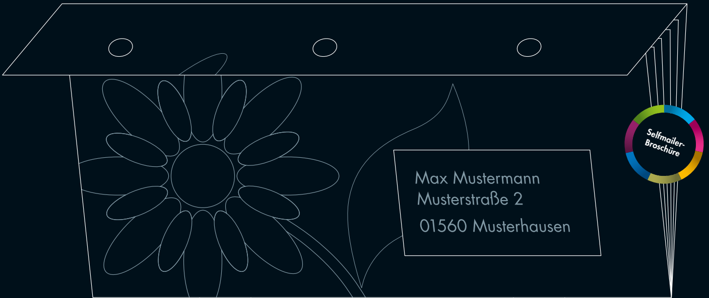
Rückstichgehefteter Selfmailer (Broschur mit adressiertem Umschlag) verschlossen mittels Heißleim-Punkten
