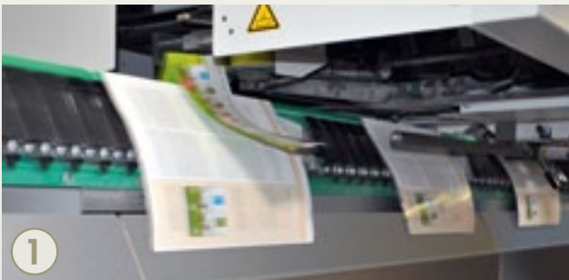
1. Produktion einer Broschüre mit Pull-Strip-Karte am Sammelhefter ST450
